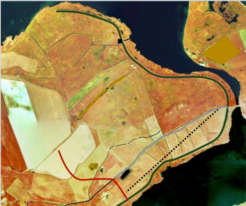
Abb 5: Maßnahmen des Renaturierungsprojektes 1993/1994. Rot: Neubau Riegeldeich. Grün: Rückbau Deich. Grau: Erhöhung Fahrdamm. Photo: aus C. Herrmann 2016
