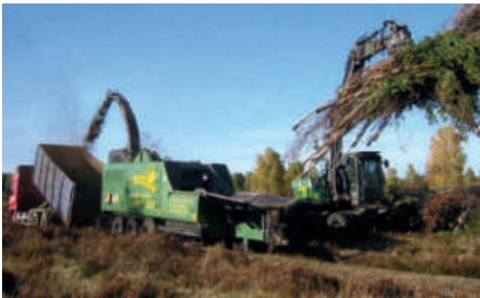
Entbuschung mit anschließender Hackung und Abtransport der Holzhackschnitzel, © A. Lorenz (o.), B. Felinks (M., u.)
