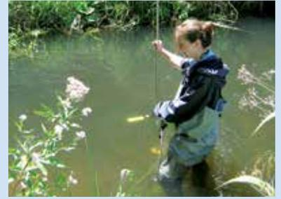
Messung der Fließgeschwindigkeit – vor allem in den Altarmen und an den Strukturelementen haben sich die Werte deutlich erhöht.
